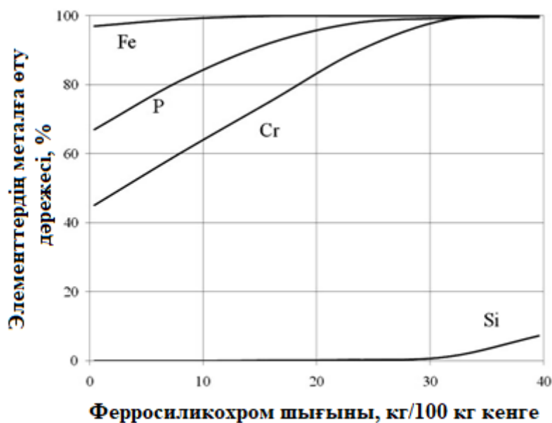
2.9-шы сурет - Силикотермиялық балқытудың екінші кезеңінде ферросиликохромды тұтынудың артуымен элементтердің металға ауысу дәрежесі
