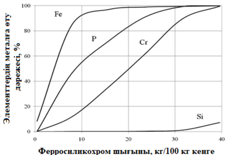
2.3-ші сурет - Силикотермиялық балқытудың бірінші кезеңінде ферросилихромы шығынын көбейту кезінде элементтердің металға ауысу дәрежесі
